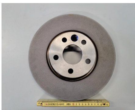
熔覆态制动盘，高速激光熔覆
